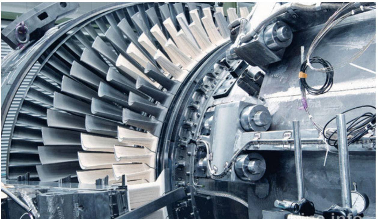
Abbildung 1: Leistungsstärkste Gasturbine der Welt (SGT5-8000H) in Irsching 4
