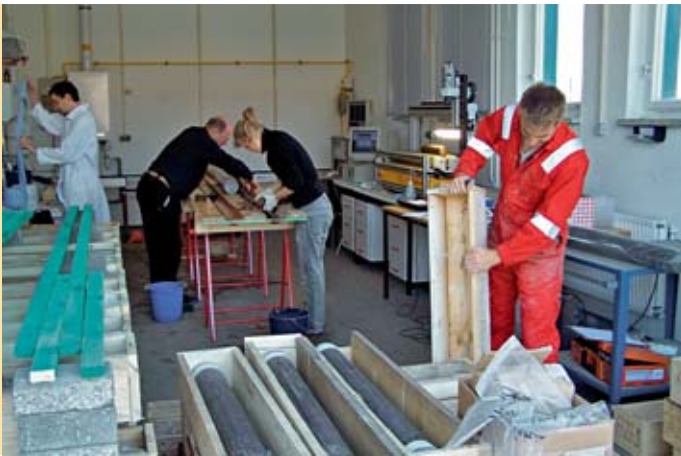
Abb. 30 Bohrkern aus Ketzin werden verpackt. Foto: Geoforschungszentrum Potsdam
