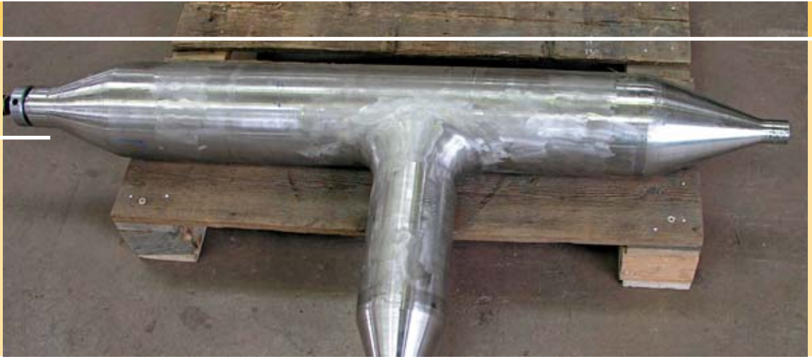
Abb. 18 Komponente aus Alloy 617. Foto: Alstom Deutschland AG
