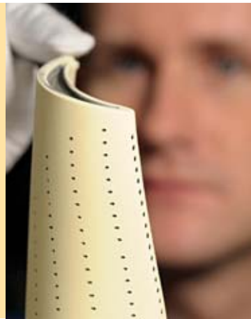
Abb. 5 Keramisch beschichtete Turbinenschaufeln. Foto: Siemens Pressebild
